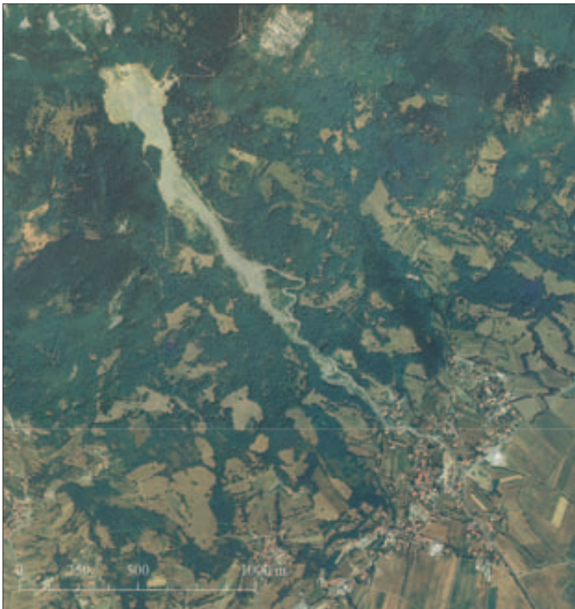
Slika 8: Zemeljski plaz Slano blato ogroža naselje Lokavec (barvni ortofotografski posnetek, © Geodetska uprava Republike Slovenije 2005).
