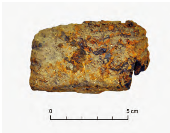
Sl. 20: Zarjavela površina kovinskega bloka. Na desni strani je vidno mesto odvzema vzorca za metalografsko analizo. Fig. 20: Corroded surface of the metal block. On the right side is visible cut of sample for metallographic analysis.
