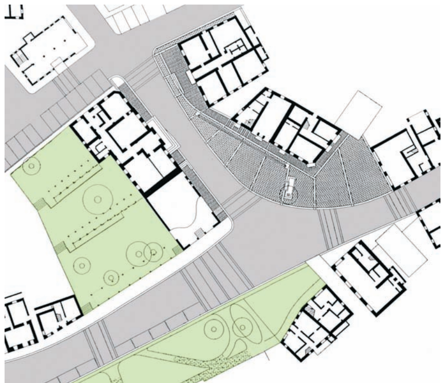
Sl. 2.16.41: Predlog ureditve Placa: promet, geometrija, tlaki, zelene površine, urbana oprema in drugo
