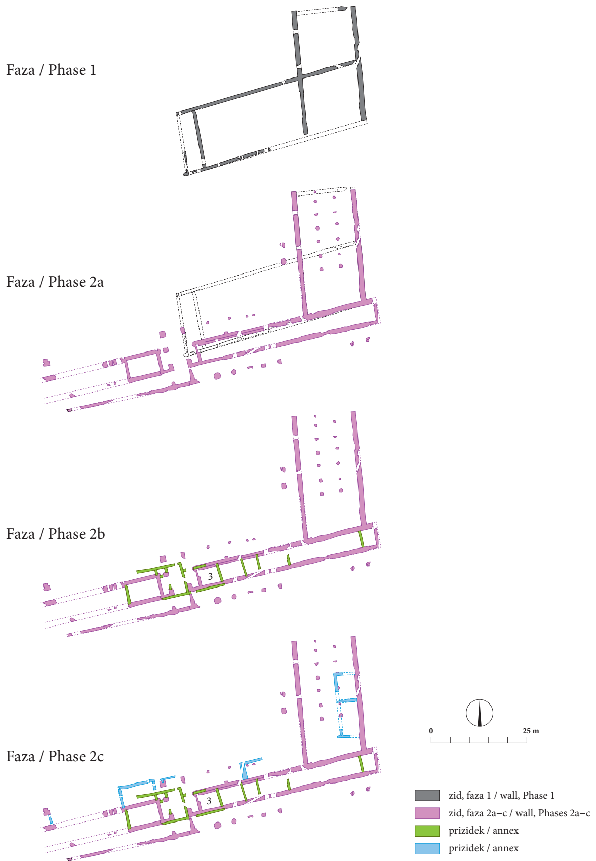
Sl. 2: Ajdovščina. Stavba III, razvoj po fazah. M. = 1:100. Fig. 2: Ajdovščina. Building III, phases of development. Scale 1:100.
