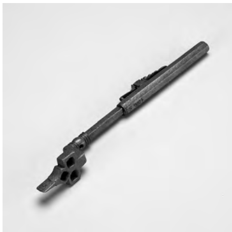
Slika 27: Napenjalni ključ kolesnega mehanizma z raztegljivim ročajem (NMS, inv. št. N 19807, foto: Tomaž Lauko).
