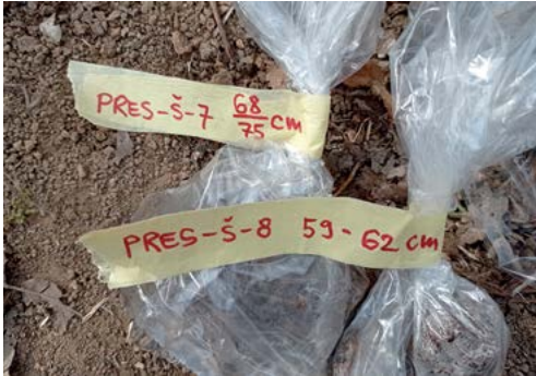
Slika 91: Uzorci za granulometrijske analize prikupljeni u vrećicama.
