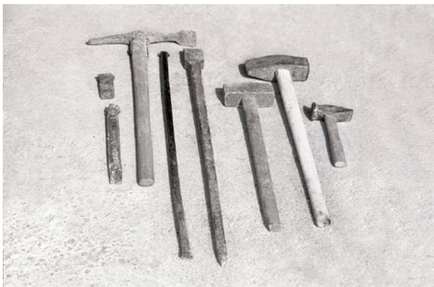
Orodje, ki so ga pri Ličarju uporabljali za kovanje skrila: klin, škrapel, kramp, puolər, štajnga s taco, bat, maca in manjši bat
