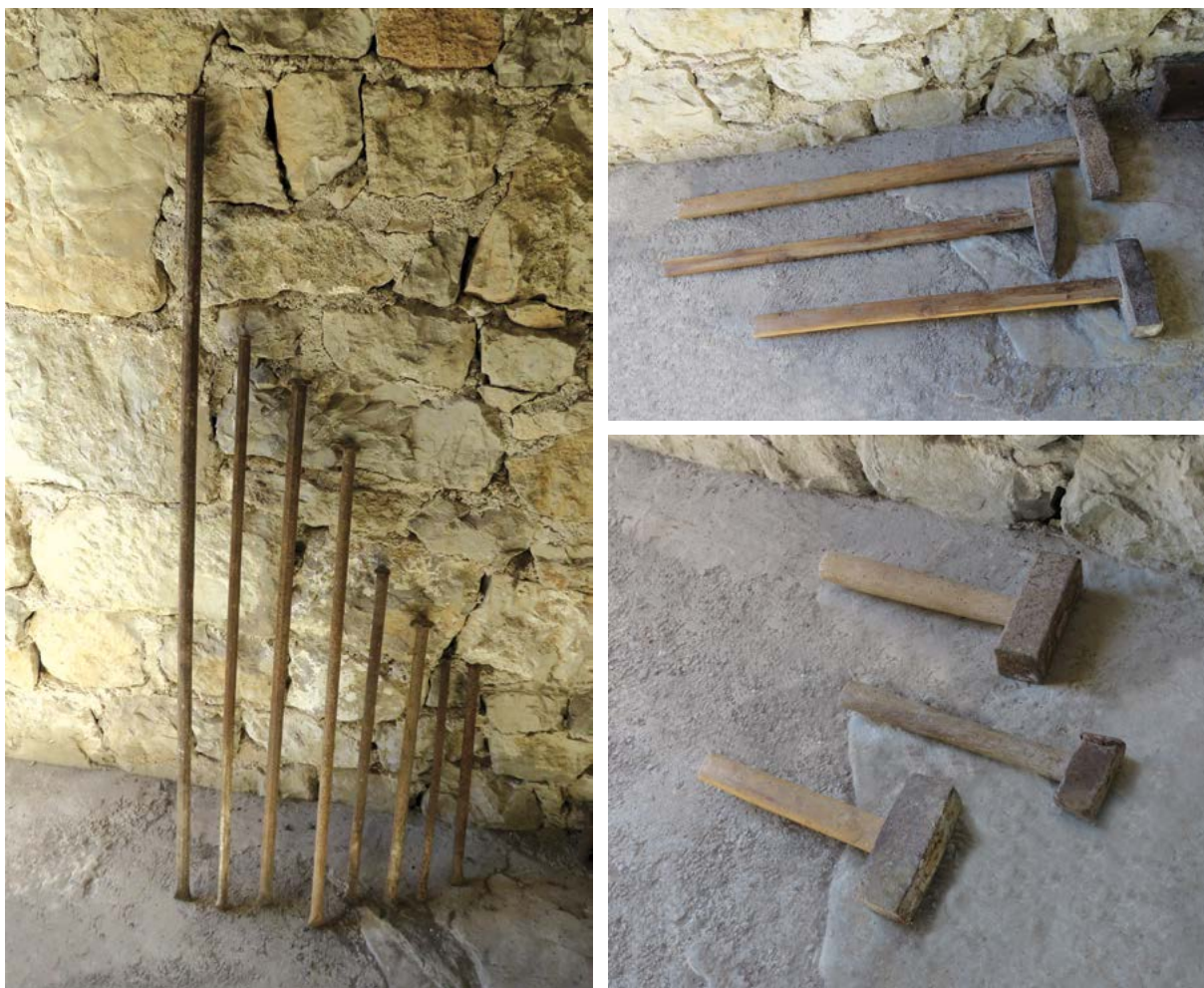
Kamnarsko orodje Jožefa Černeta: levo minerski svedri, desno zgoraj dvoročni zidarski bat s sekiro, dvoročni zidarski bat s konico in dvoročna macola z obloma čeloma, spodaj dve jekleni macolici in obrabljena železna macolica
