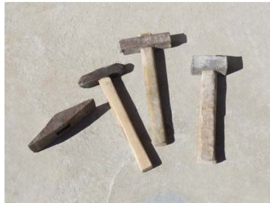
Orodje, ki ga je uporabljal Andrej Pavlin: krem-pač, dvozub, zobato kladivo in macolica
