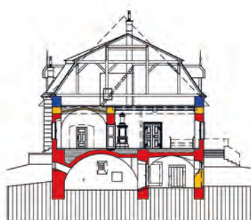
6. Izrisi zahodne in južne fasade v treh glavnih fazah stavbnega razvoja in prereza stavbe v obliki iz okoli leta 1908 (© risal Igor Sapač)
