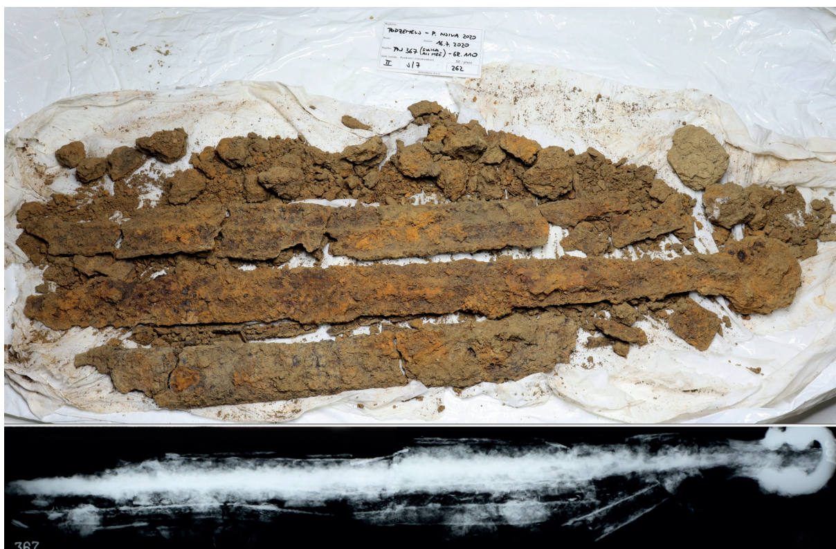
Sl. 1: Podzemelj, Pezdirčeva njiva, grob 110. Ostanki železnega meča pred konserviranjem-restavriranjem in rentgenski posnetek: 85 kV, 4 mA, 30 s (preiskava: Janko Vodišek, IMK, foto: Nataša Nemeček).
