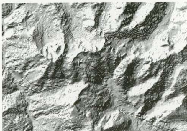
Slika 2: SPOT DMR 20 z značilnim stopničanjem.
