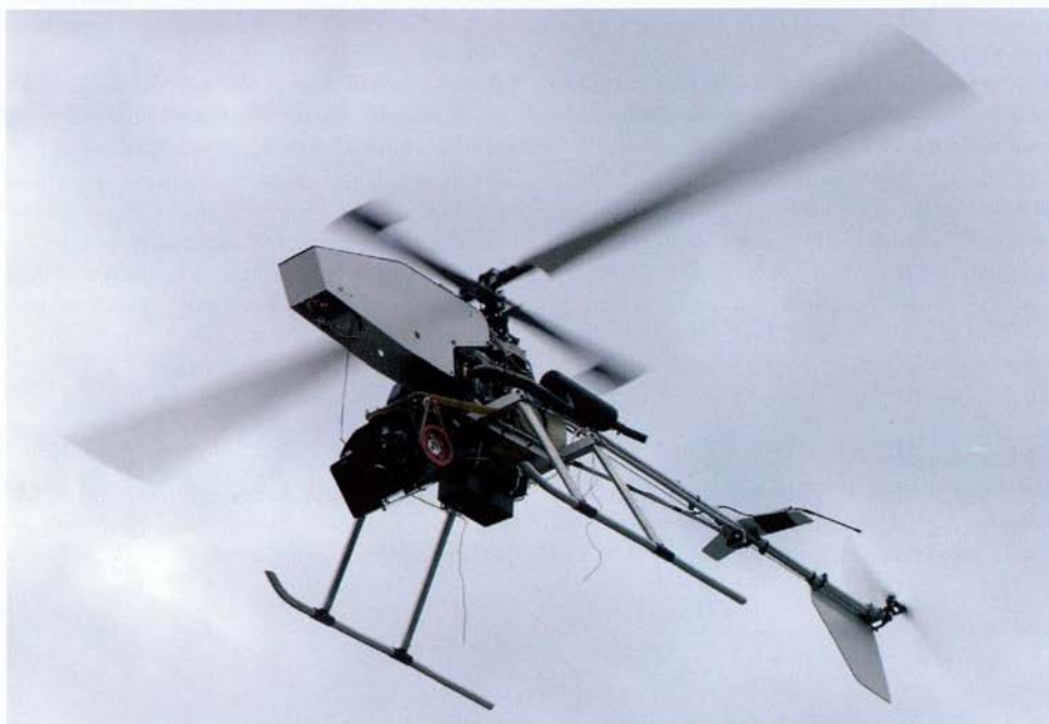
Slika 1: Model helikopterja z digitalnim fotoaparatom.
