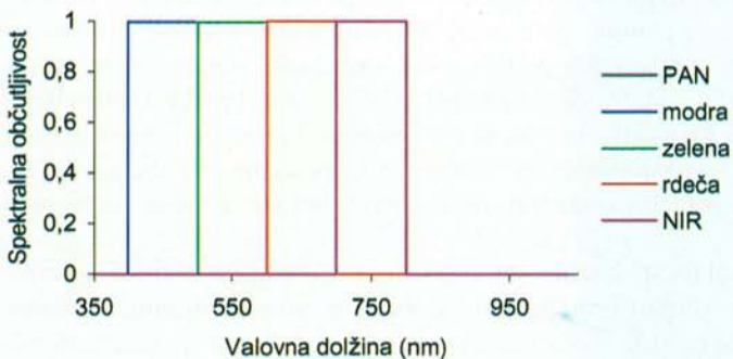
Slika 1c: Teoretično idealen primer ujemanja spektralnih občutljivosti pankromatskega pasu in posameznih spektralnih pasov.
