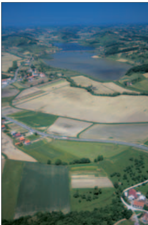
Slika 102: Z regulacijskimi in melioracijskimi deli so na rečici Pesnici za umetnimi nasipi nastala številna zaježitvena jezera, med katerimi je največje Perniško jezero.
