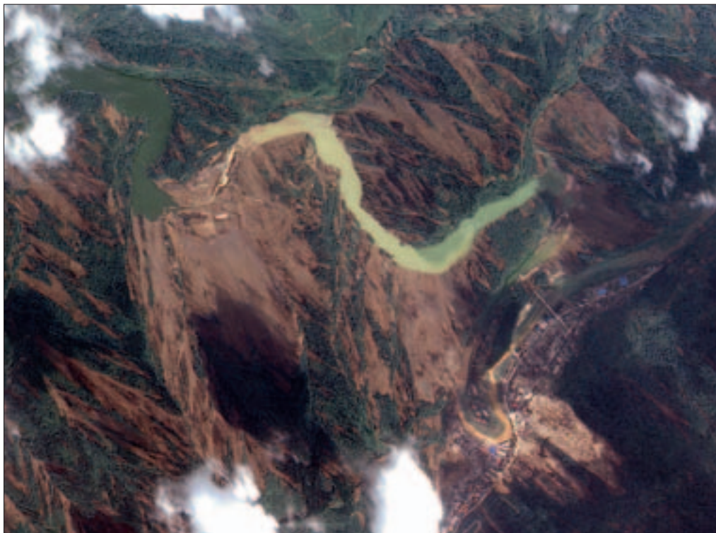
Slika 118: Reka Jianjiang je za 124 m visokim plazom, ki se je sprožil ob potresu v Sečuanu na Kitajskem maja 2008, v 26 dneh ustvarila jezero s 229,5 milijona m 3 vode. Jezernica se je prebila čez plaz po umetnem kanalu, ki se je zaradi erozije v dveh dneh močno razširil. O veliki erozivnosti reke priča kalna voda, ki je vidna na posnetku (© Image Science & Analysis Laboratory, NASA Johnson Space Center; NASA ... 2008).
