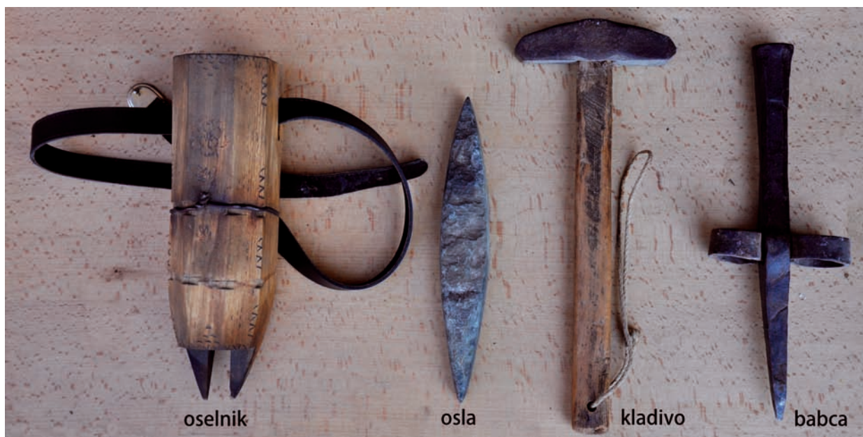
Orodje za brušenje in klepanje kose: “osovnik” (oselnik), “uaslo” (oslo), “b` t” (kladivo) in železna “babca” (babica)
